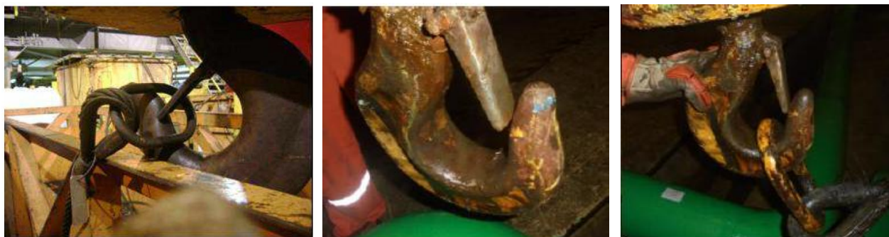
Exemplos de gancho com trava inadequada
